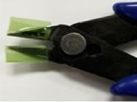
A close-up photograph of the pliers with the green tape covering both sides of the blade. The pliers are held by blue handles.                                                                                                            | <p>Répétez le même processus sur le côté opposé.</p> <p>※ Si le ruban adhésif commence à se soulever parce qu'il est usé, enlevez-le et fixez-en un nouveau.</p>                                              |
