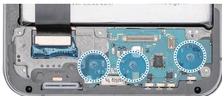
5 À l'aide de la pincette plastique ou du levier de démontage, soulevez l'encoche de séparation en haut et à droite du module du port de chargement et retirez-le.
