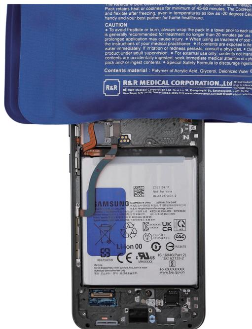
2 Avant que le coussinet thermique ne refroidisse, servez-vous de l'aiguille d'éjection du compartiment pour carte SIM pour éliminer l'adhésif collé entre l'objectif avant et le module d'écran.
