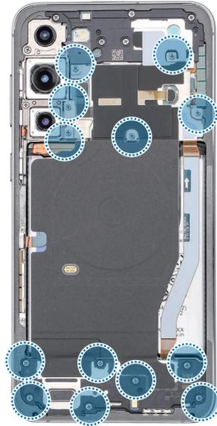
2 Détachez les 2 connecteurs du module NFC et du module UWB à l'aide du médiator.
