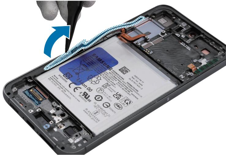
3 Retirez la partie inférieure du module d'antenne 5G mmWave.
